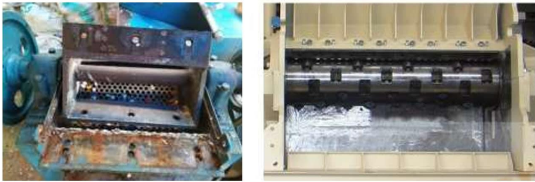
Gambar. 2. Jenis mesin pencacah plastik (a) Crusher (b) shredder grinder
