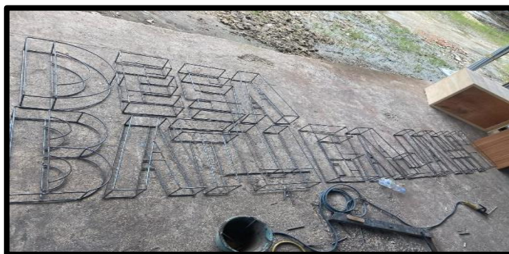
Gambar 2. Proses pembuatan kerangka besi tulisan desa batu gajah
